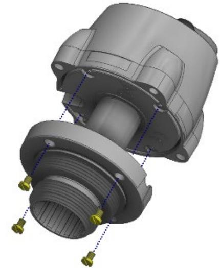
**Remarque :** Cet adaptateur peut être utilisé avec des tubes guideur d'ondes de 36mm. Le tuyau doit être solidement fixé au capteur, sans le forcer, à l'aide des deux vis sans tête (vis grub) fournies et serré à la main avec une clé Allen de 1,5mm. (Attention : un serrage excessif des vis sans tête peut endommager le plastique).
