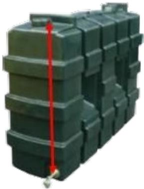
**Remarque :** le bas du tuyau doit être à au moins 5 cm du fond de la cuve pour éviter qu'il ne le touche en cas de changements dimensionnels de la cuve dû aux changements de la température.
